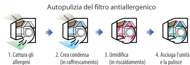
Le 4 fasi del processo di sanificazione eliminano gli allergeni catturati dal filtro.
